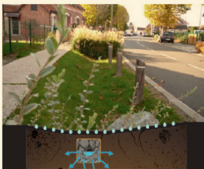
Noue avec tranchée d'infiltration
